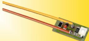
**Platine mit zwei LEDs für Hausbeleuchtung:**
